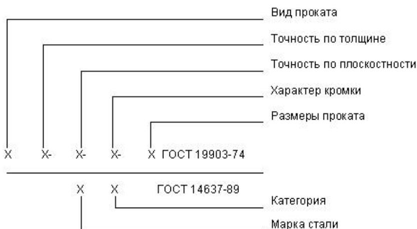
Примечание. Параметры и характеристики проката, приведенные в схеме, если они не указаны в заказе, устанавливаются изготовителем и в обозначении не приводятся.
